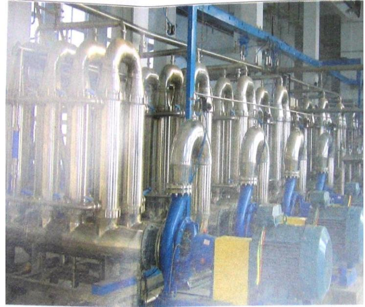
**发酵液提取陶瓷膜成套设备**
